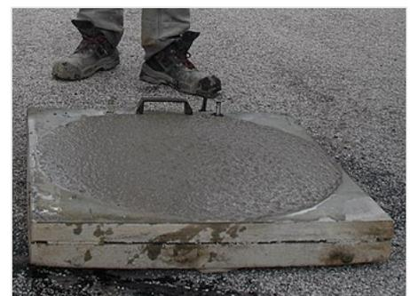
... und der Beton breitet sich durch das definierte Anheben und Fallenlassen der oberen Tischplatte aus. Danach wird der Durchmesser gemessen. Hier wurde ein sehr fließfähiger Beton geprüft. Ausbreitmaß: ca. 700 mm.
