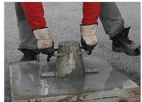
Der bis zum Rand mit flüssigem Beton gefüllte Trichter wird hochgezogen ...
